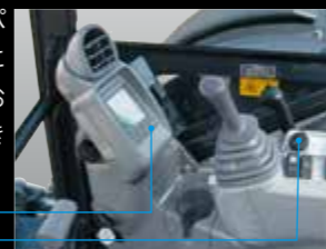
ECO/PWRモード切替えスイッチ エンジンコントロールダイヤル
